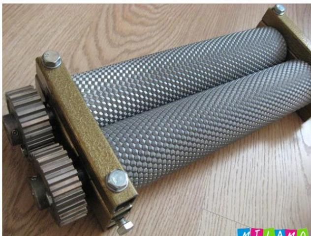
Оборудование для пчеловодов! Вальцы для изготовления вошины. Электровоскотопка масляная - стерилизатор ВМС-37. Емкость с электроподогревом для изготовления заготовок вошины (гладкий восковой лист) - отличная альтернатива гладким вальцам! Купи Вальцы и делай вошину сам! 89237543906
