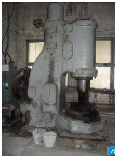
В Самарской области, молот ковочный пневматический одностоечный М415А, масса падающей части 400кг, в отличном состоянии, не подключен. Габарит слева-направо, мм - 3105, Габарит спереди-сзади, мм - 1270, Высота над уровнем пола, мм - 2720, Масса молота без шабота, кг - 8700, Масса шабота в сборе, кг - 13500. Цена 240т.р. Дополнительные фото отправлю по запросу 2771749@mail.ru
