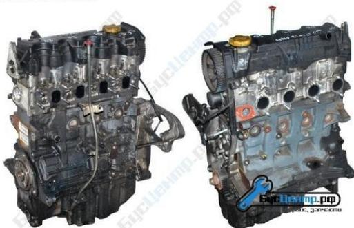
Мотор (Двигатель) без навесного оборудования 1.9MJET Fiat Doblo -09
