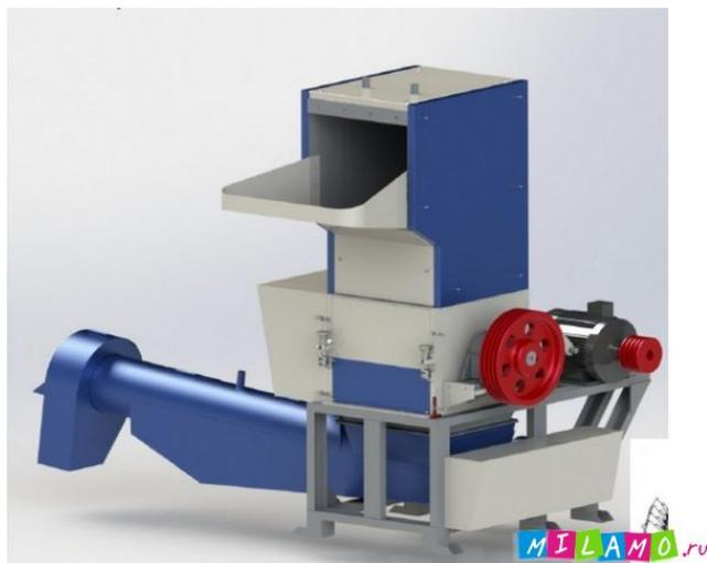
Моющая дробилка сочетает в себе дробление с первичной отмывкой и шнековый транспортёр с подачей воды. Отмывка земли, песка, бумаги осуществляется за счёт высоких оборотов и все загрязнения уходят вместе с водой через отверстия в теле цилиндра шнека. Благодаря этому в дальнейший цикл мойки не попадают крупные загрязнения. Версии (DMS - моющая дробилка, DLS - расположение ножей по типу «ласточкин хвост») оборудованные транспортировочным шнеком. В наличии в Подольске.
