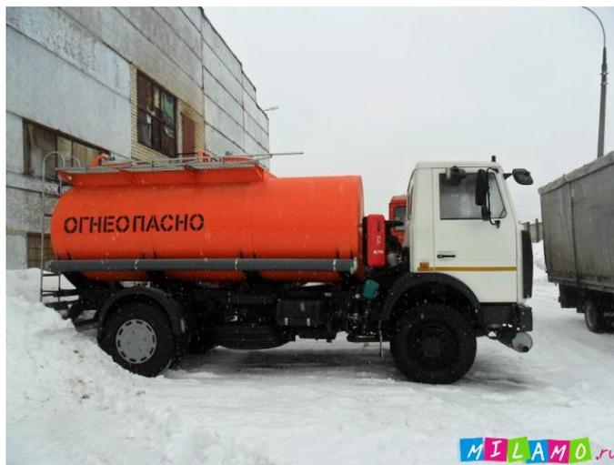
Автоцистерна-бензовоз предназначена для транспортировки и кратковременного хранения светлых нефтепродуктов плотностью 0,86 т/м3.
